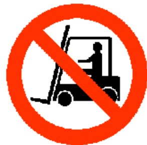
PROHIBIDO A LOS VEHÍCULOS DE MANUTENCIÓN
